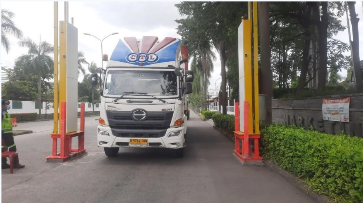
Aplikasi sistem RPM aktif dalam melakukan pemindaian otomatis muatan truk logistik kargo secara real-time.
